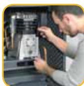
Dotati di uno sportello anteriore apribile che facilita l'accessibilità e la manutenzione di tutti i componenti interni. Il livello dell'olio è ben visibile e il rabbocco è semplice grazie alla favorevole posizione del gruppo pompante.
