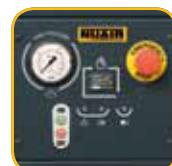
Il pannello comandi che include tutta la strumentazione necessaria per il funzionamento della macchina, è posizionato in modo tale da facilitarne la lettura. Le versioni con avviamento stella triangolo hanno una centralina elettronica con spie per la segnalazione di anomalie.
