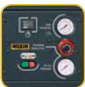
Pannello di controllo con doppio manometro, regolatore di pressione, contatore e interruttore di accensione ON/OFF posizionati sulla macchina in modo da garantire una facile lettura e utilizzo.
