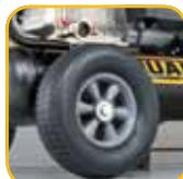
Le ruote semigonfiabili di grandi dimensioni permettono la movimentazione su qualsiasi tipo di terreno.
