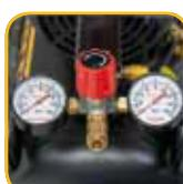
Grandi manometri posizionati sul compressore garantiscono una facile lettura, manopola riduttore di pressione dotata di innovativa regolazione "a scatti".
