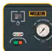
Il pannello comandi che include tutta la strumentazione necessaria per il funzionamento della macchina, è posizionato in modo tale da facilitarne la lettura. Le versioni con avviamento stella triangolo hanno una centralina elettronica con spie per la segnalazione di anomalie.
