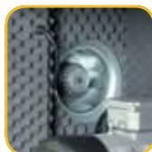
Ventilazione forzata che permette un miglior raffreddamento delle parti interne della macchina (sui modelli AIR SIL 2-3).
