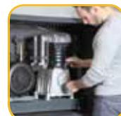
Dotati di uno sportello anteriore apribile che facilita l'accessibilità e la manutenzione di tutti i componenti interni.
